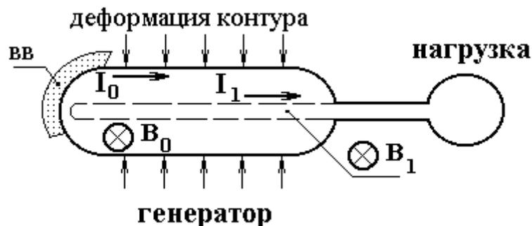
Рис. 0.1. Схема работы взрывомагнитного генератора тока. Давление начального магнитного поля с индукцией  $B_0$  мало и не препятствует разгону оболочки с током продуктами взрыва ВВ.
