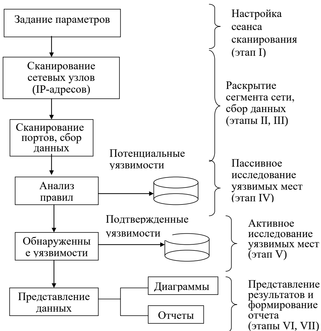
Рис.1. Схема проведения сканирования сегмента сети.
