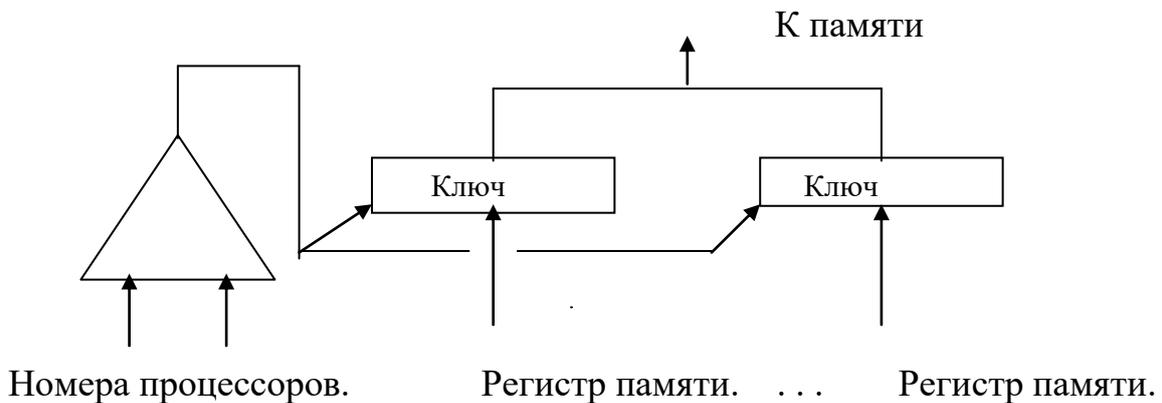
Здесь “Номер процессора” - виртуальный номер процессора, записанный в слове состояния физического процессора. Количество номеров, из которых производится выбор, очевидно, равно числу физических процессоров. Возможны различные схемы выбора, например, шкала номеров
