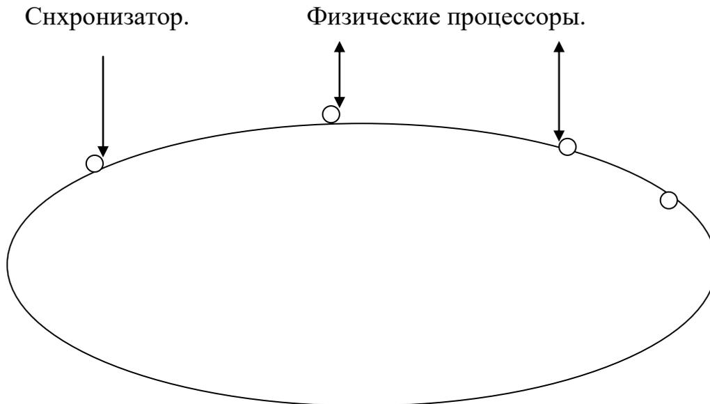
Физические процессоры связаны с кольцом через порты ввода и вывода. Каждому занятому физическому процессору соответствует в кольце его виртуальный.
