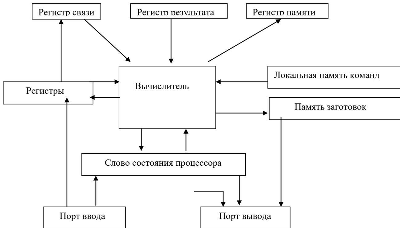
Рассматриваемая архитектура подразумевает наличие двух видов процессоров – описанного выше физического и виртуального. Виртуальный процессор это всего лишь объект, содержащий состояние процессора. Он располагается в кольце виртуальных процессоров.
