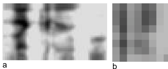
Рис. 2. Итоговое масштабирование и нормализация a) Спектрограмма слова. b) Вектор свойств слова.
