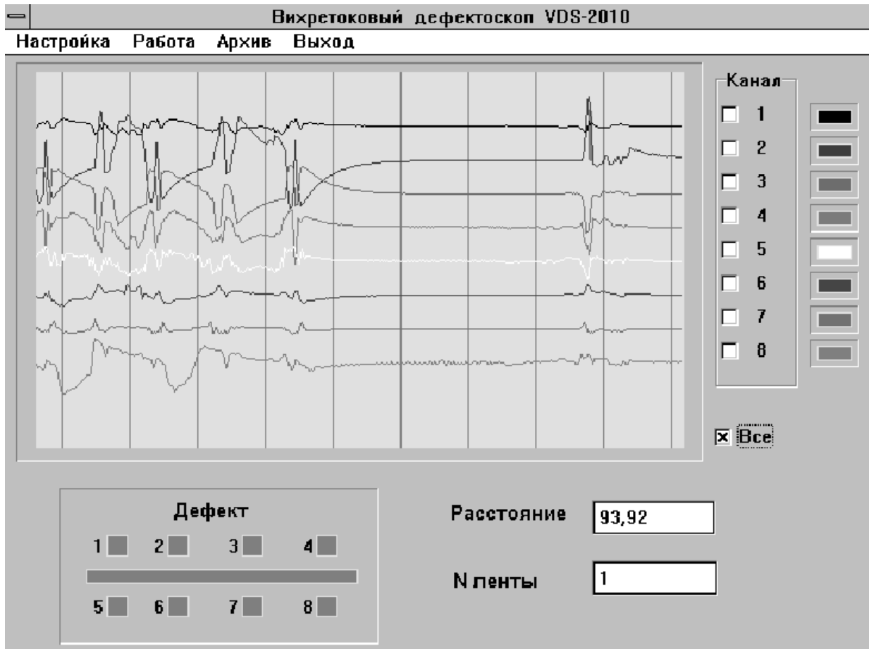
Рис. 7. Пример работы уровня ФД для описания контроля и диагностики дефектов металлической ленты.
