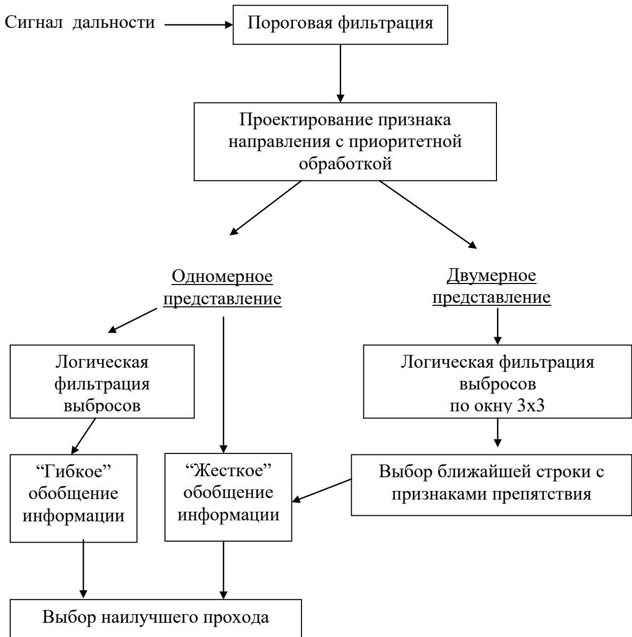
Рис. 3. Три схемы обработки дальнометрической информации при локальном планировании движения, описанные в качестве альтернативных блок-схем детектора препятствий.
