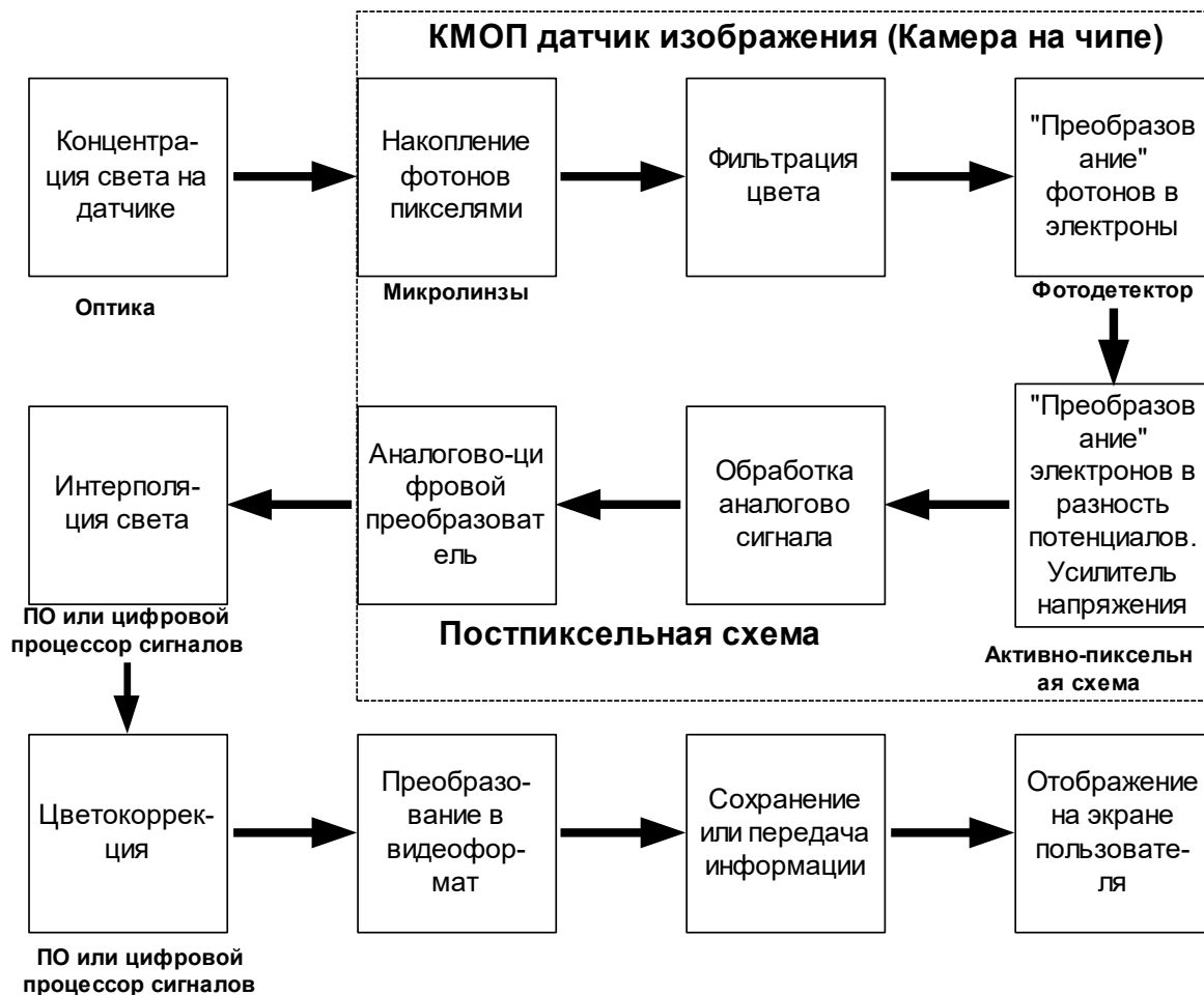
Рис.1. Роль КМОП-датчика в цифровой камере
