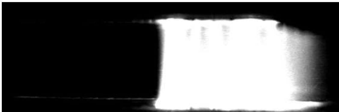
Рис. 1.2. Фотография свечения разрядного промежутка, пересекаемого ударной волной (волна движется слева направо)
