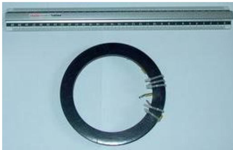
Рис.8. Катушка для макета спутника
