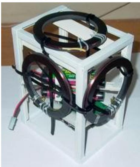
Рис.7. Макет спутника с установленными во взаимно перпендикулярных плоскостях тремя катушками
