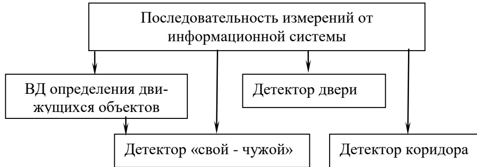
Рис. 2. Принципиальная схема функционирования используемых виртуальных датчиков
