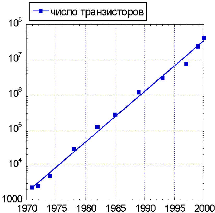
Рис. 6. Иллюстрация закона Мура на 1970-2000 г.г. График представлен в логарифмическом масштабе. Удвоение числа транзисторов происходит примерно каждые 25 \pm 1 месяцев. Источник: [15].
