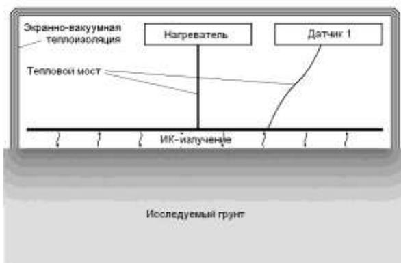
Рис. 13. Определение теплопроводности радиометрическим методом.
