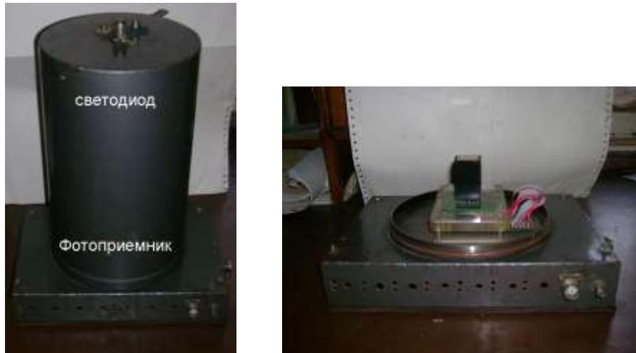
Рис.2. Блока испытания многоанодного ФЭУ Н7546В
