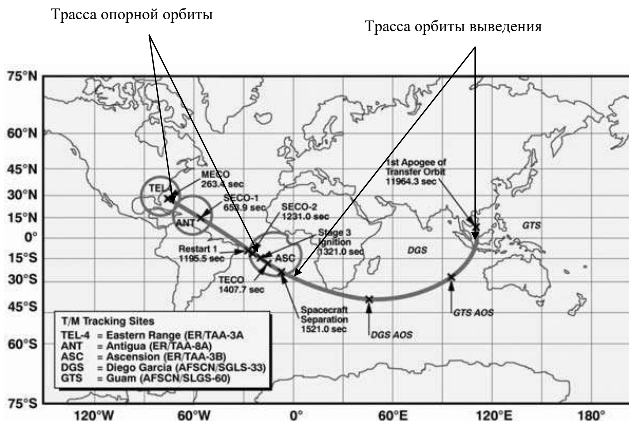
Рис. 7б. Запуск 2004-045. Трассы орбиты выведения и опорной орбиты КА. Рисунок из материалов компании Boeing
