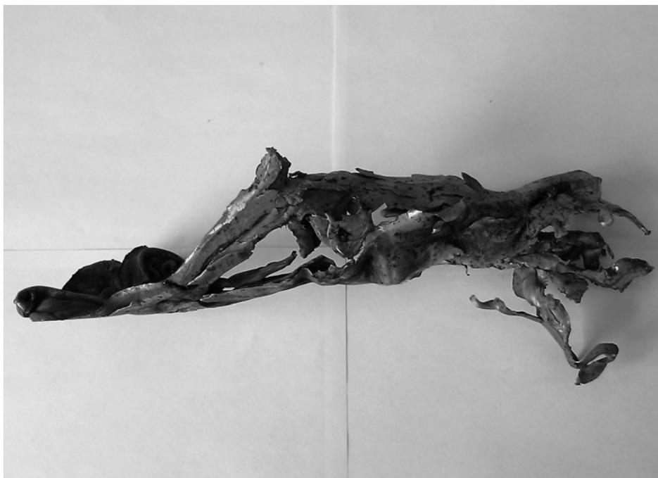
Рис. 2. Фрагмент ленты лайнера после проведения экспериментального запуска МК
