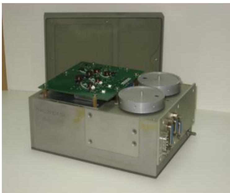
Рис. 3. Внешний вид блока управления системой ориентации, в состав которого входят двигатели-маховики
