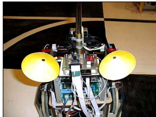
Рис. 1. Робот "Аргонавт-2" с системой слуха
