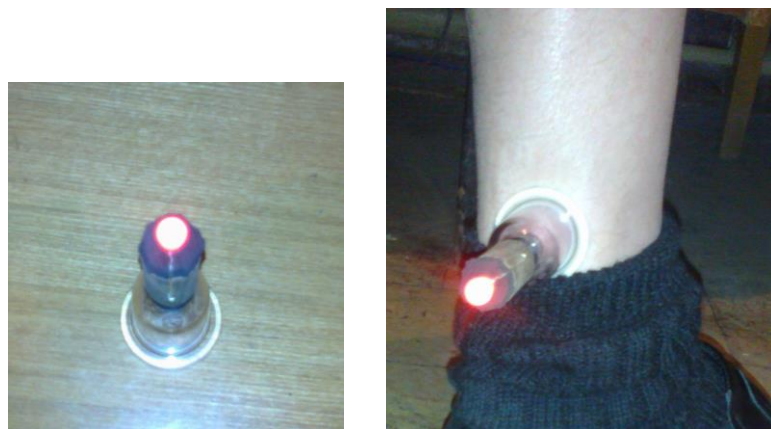
Рис. 2. Конструкция светящегося маркера (слева: общий вид; справа: крепление на ноге человека).
