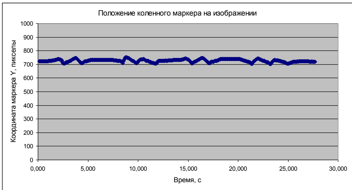
Рис. 8. Результаты определения положения коленного маркера на изображении. ( \sigma_x \approx 4.4 пиксел, \sigma_y \approx 1.2 пиксел).
