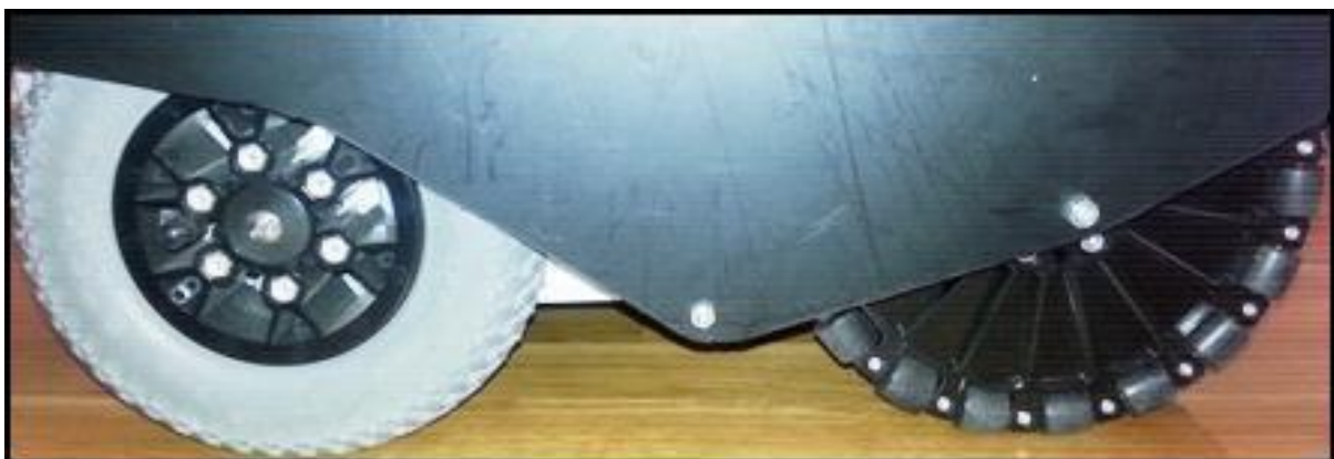
Рис. 2. Передние и задние колеса робота РБ-2
