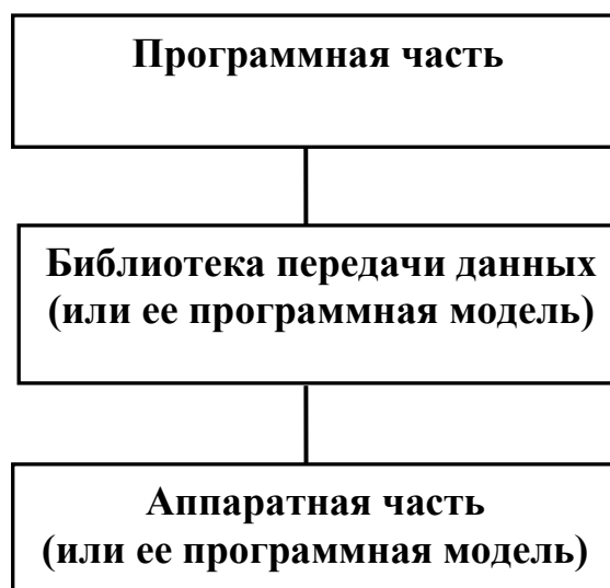
Рис. 1. Структура приложения для гибридно-реконфигурируемого вычислителя.
