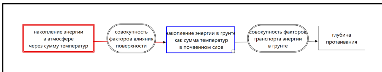
Рис.3. Упрощенная модель оценки глубины протаивания грунта.
