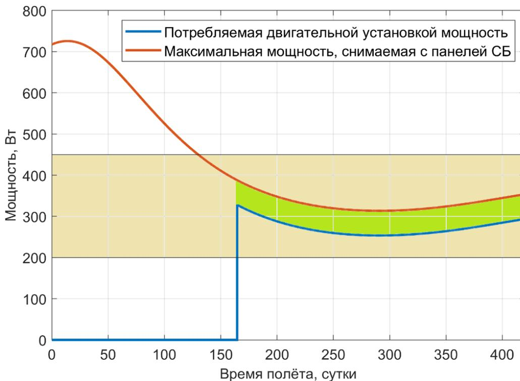
Рис. 12. Энергопотребление маршевой ДУ в течение межпланетного перелёта. Красная линия показывает максимальную мощность, генерируемую панелями СБ. Бежевым покрашен рабочий диапазон СПД-50М, зелёным – резерв 60 Вт
