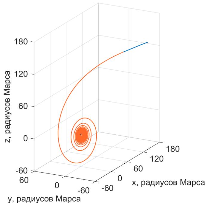
Рис. 14. Переход межпланетного участка траектории (синим) в участок скрутки (красным) к рабочей орбите  $300 \times 10\,000$  км с наклоном  $86.3^\circ$
