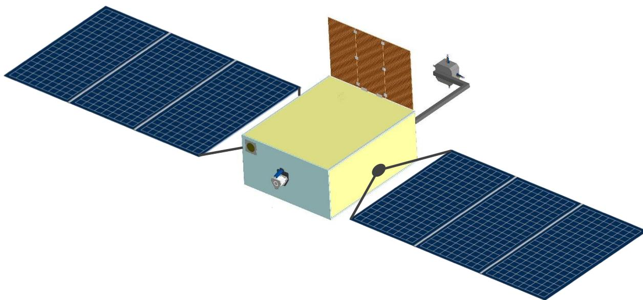
Рис. 2. Внешний вид МКА с развёрнутыми панелями солнечных батарей
