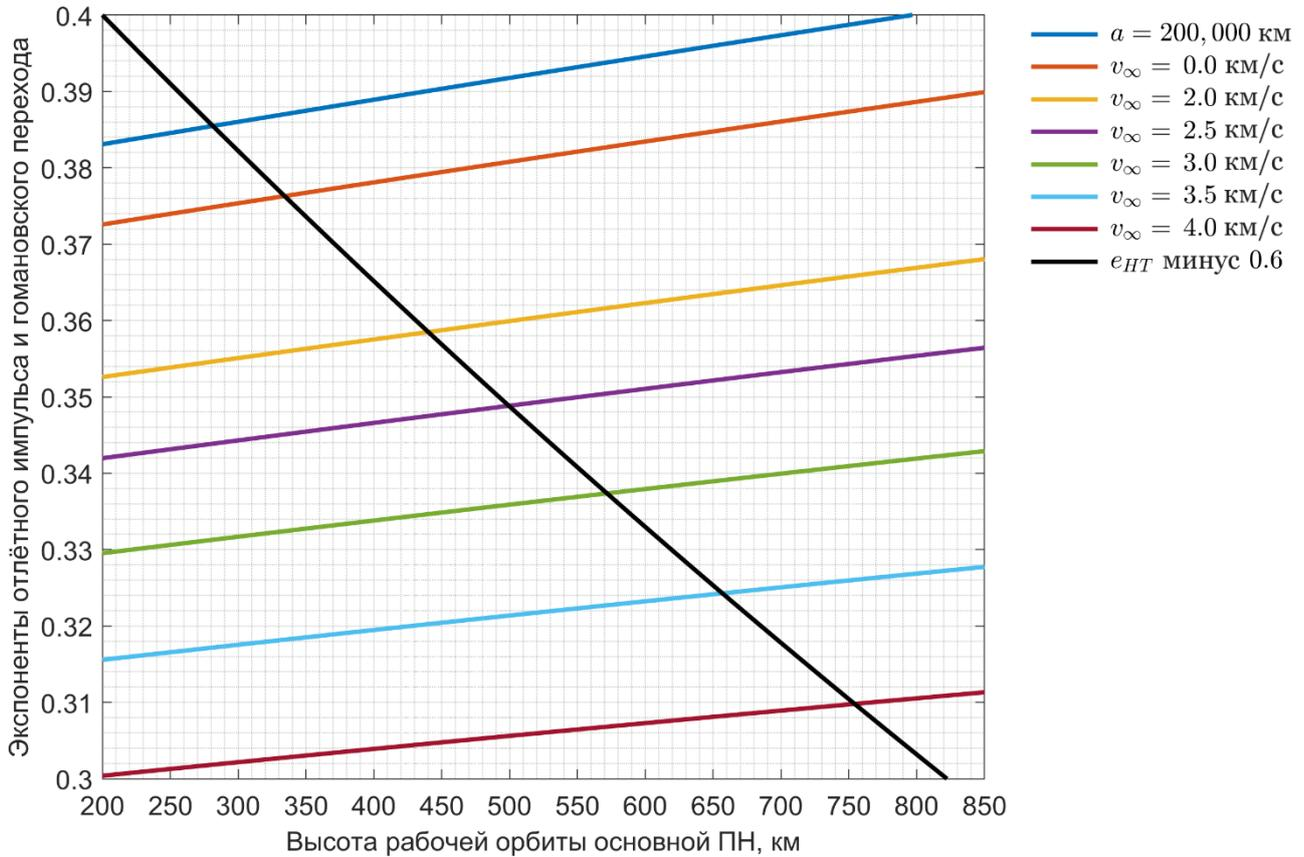
Рис. 9. Экспоненты отлётного импульса, сообщаемого РБ «Фрегат» на рабочей орбите основной ПН, и экспонента перехода на эту орбиту с орбиты 200 км, уменьшенная на 0.6 для удобного отображения в том же диапазоне значений.
