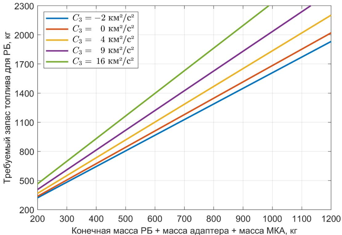
Рис. 10. Масса топлива, необходимая РБ с удельным импульсом 333.2 с для разгона МКА с орбиты 200 км до различных уровней отлётной энергии
