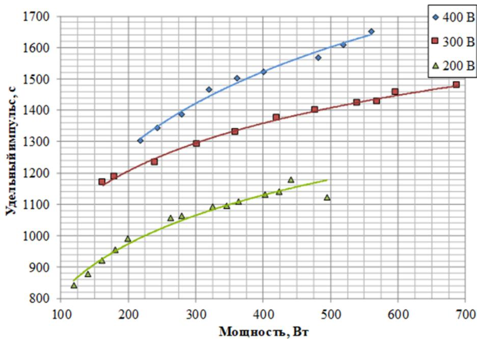
б) Удельный импульс как функция потребляемой мощности
