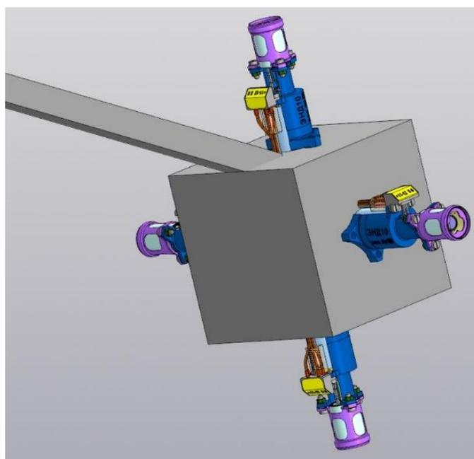
Рис. 4. Четыре газовых двигателя ориентации, размещаемые на выносном кронштейне
