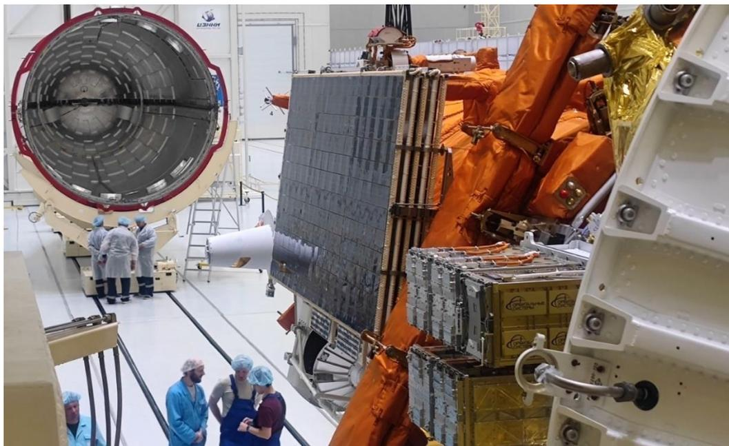
Рис. 7. Аппарат «Метеор-М» № 2-3 и контейнеры с попутно запускаемыми кубсатами, смонтированные на адаптере РБ «Фрегат», перед накаткой головного обтекателя ракеты «Союз-2.1б». Фото: Роскосмос
