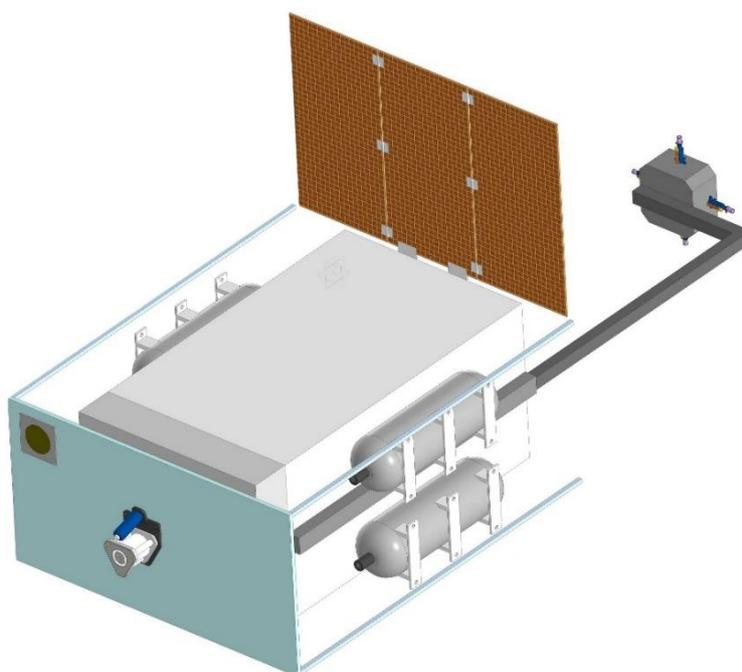
Рис. 3. Размещение баков с ксеноном в корпусе МКА (облицовка корпуса снята, панели СБ не показаны)
