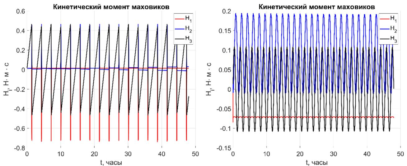
Рис. 15. Эволюция кинетического момента маховиков в случае периодического разворота (слева) или постоянной закрутки (справа) МКА вокруг вектора тяги
