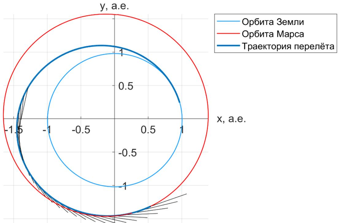
Рис. 11. Оптимальная траектория перелёта Земля–Марс с датой старта 08.10.2026 и длительностью 420 дней (активный участок с 21.03.2027 по 02.12.2027). Общие затраты ксенона 37.6 кг. Отлётный гиперболический избыток  $v_{\infty} = 2812$  м/с
