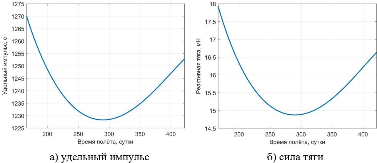
Рис. 13. Параметры работы маршевого двигателя СПД-50М на активном участке оптимальной траектории
