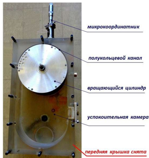
Рис. 2. Вид экспериментальной установки
