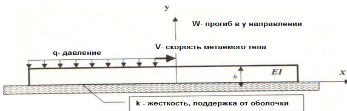
Рис. 11. Система координат и расчетная модель ( w -прогиб по координате y , q – давление, V – скорость метаемого тела в направлении оси x , k – жесткость поддержки).
