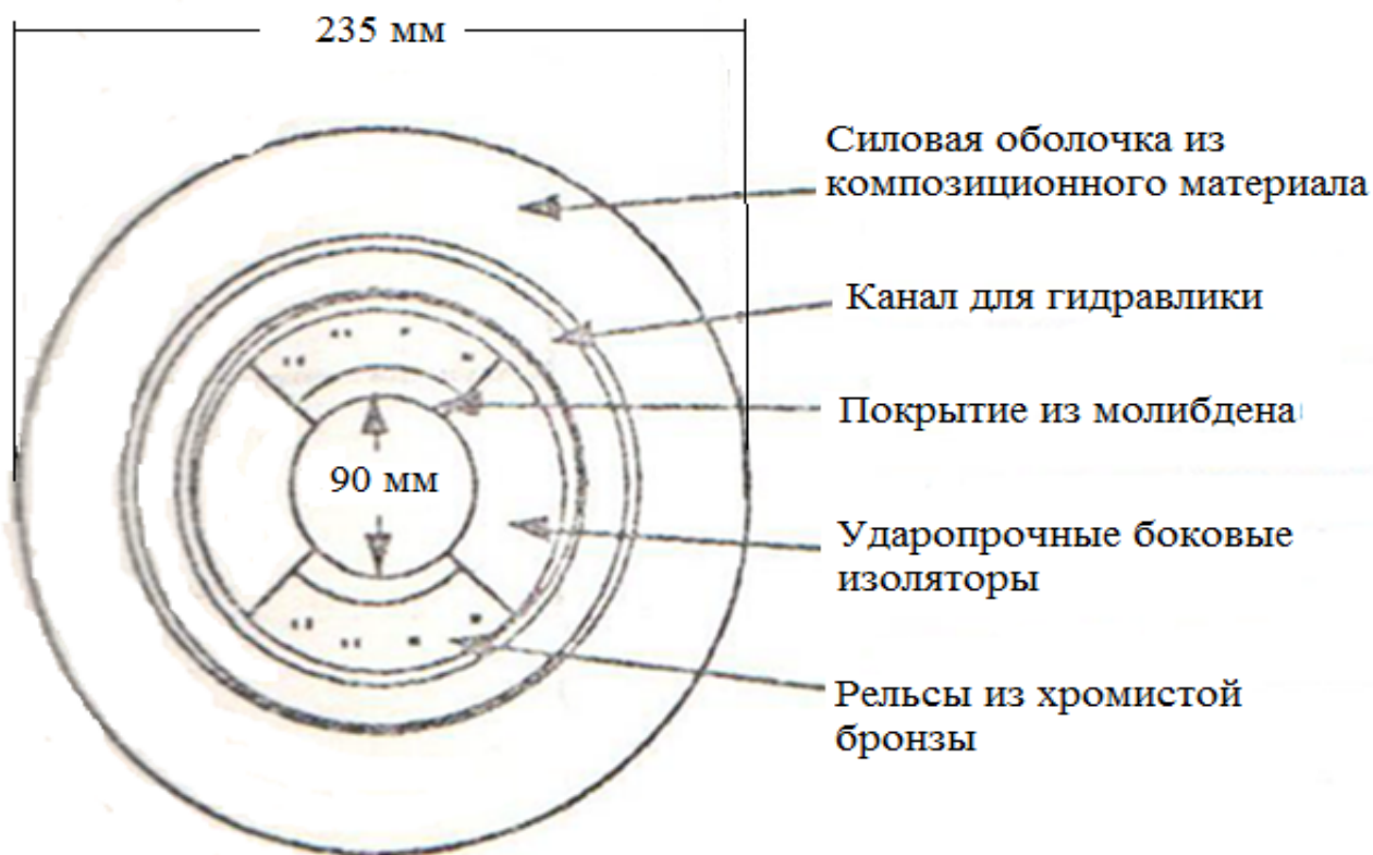
Рис. 9. Поперечное сечение ускорителя фирмы СПАРТА [12].
