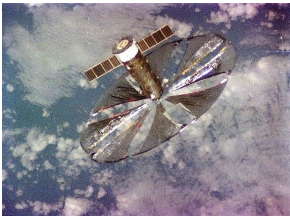
Рис. 3. Фото развёрнутой тонкоплёночной конструкции эксперимента «Знамя-2» со станции Мир. Фото: ПАО «РКК Энергия».
