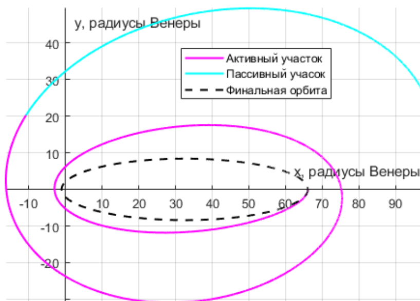
Рис. 7. Торможение КА на орбите вокруг Венеры с выходом на высокоэллиптическую орбиту с высотой 400 x 400 000 км
