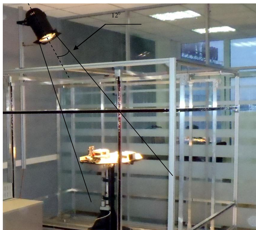
Рис. II.1. Расходимость луча имитатора Солнца
