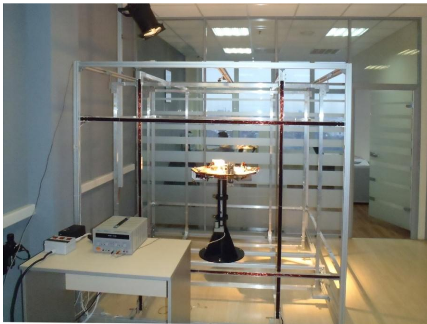
Рис. 4.1. Стенд для полунатурных испытаний системы ориентации
