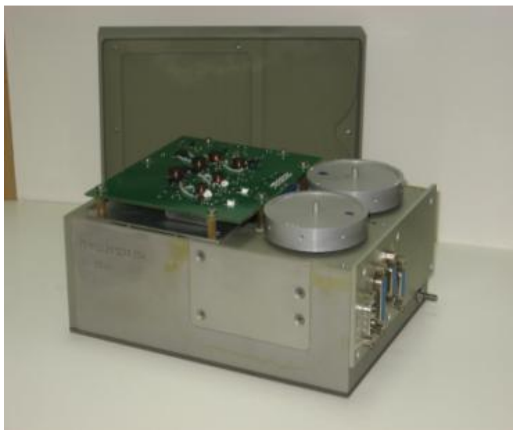
Рис. 3.3. Внешний вид блока управления системой ориентации
