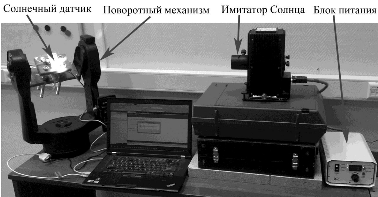
Рис 3.1 Установка для проведения калибровки
