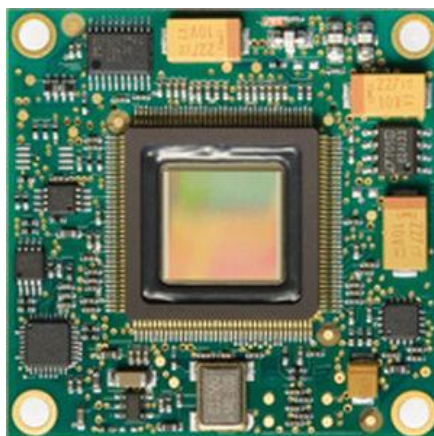
Рис 1.6 CMOS матрица фотокамеры
