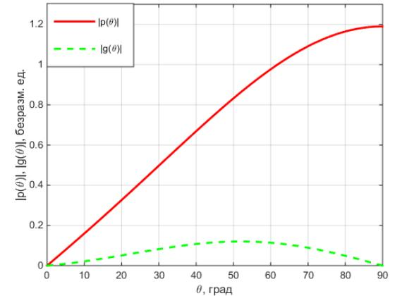
Зависимость компонент аэродинамической силы от угла
