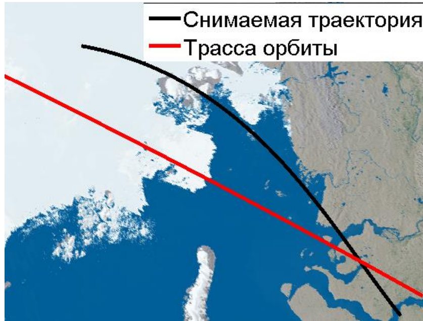
Рис. 3. Маршрут съемки и подспутниковая траектория
