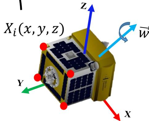
$X_i(x, y, z)$ : местоположение конкретных точек объекта относительно его связанной системы координат XYZ известно
