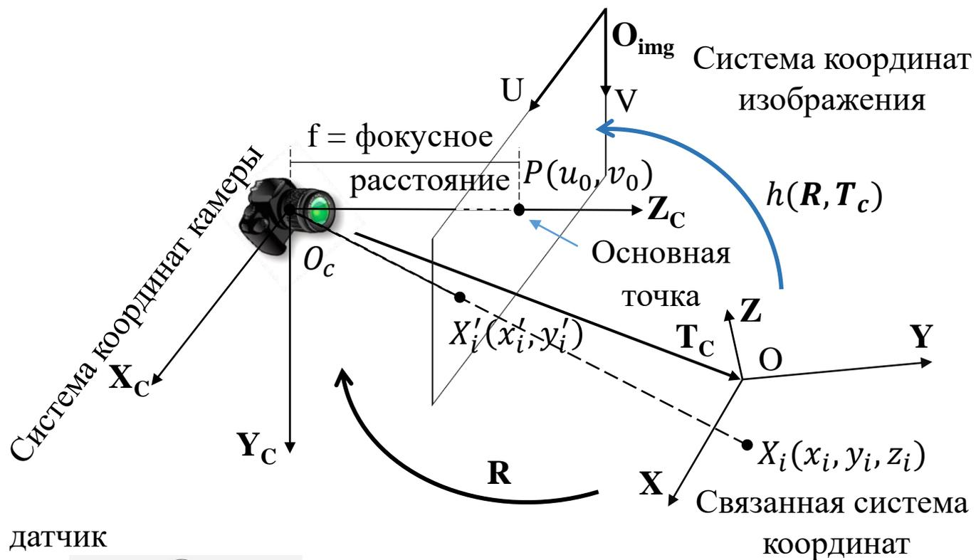
Описывает математическое соотношение между координатами точки в трехмерном пространстве и ее проекцией на плоскость изображения
