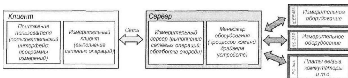
Рис. 1.1 Многоуровневая структура системы дистанционного управления, разработанная университетами г. Падовы и г. Турина (Италия)
