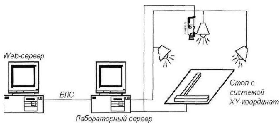
Рис. 1.6 Структурная схема лабораторной установки дистанционного лабораторного практикума, реализованного в системе PEARL
