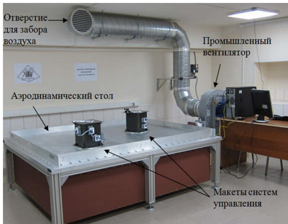
Рис. 2. Стенд КОСМОС. Стол с воздушной подушкой.
