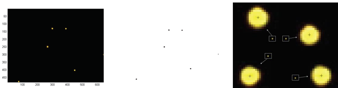
Рисунок 5. Сегментирование изображения. Оригинальное, отфильтрованное, с центроидами
